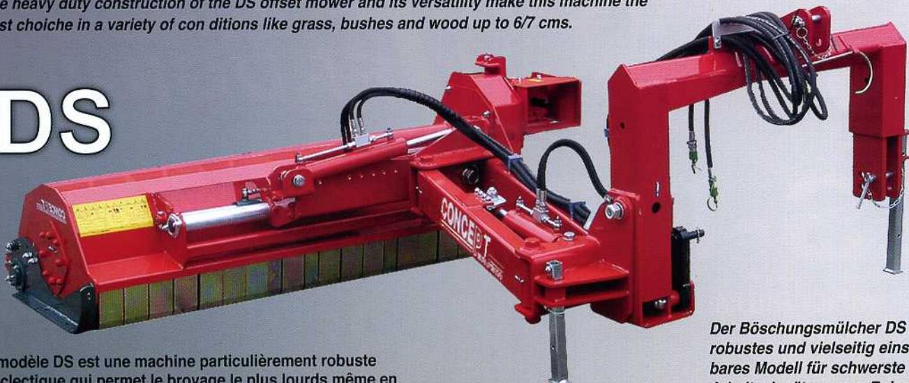
Le modèle DS est une machine particulièrement robuste et éclectique qui permet le broyage le plus lourds même en présence d'arbustes et buissons jusqu'à 6/7 cm. de diamètre.
