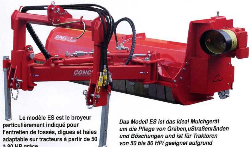
Le modèle ES est le broyeur particulièrement indiqué pour l'entretien de fossés, digues et haies adaptable sur tracteurs à partir de 50 à 80 HP grâce à sa structure légère et robuste au même temps. La tête de coupe du bien rodé modèle ET assure une coupe parfaite en chaque situation.
