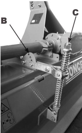
Le modèle **KF** a une chaîne pour la régulation de la tôle arrière.
