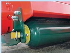
**SISTEMA QUICK HUB** in caso di rottura il mozzo completo può essere sostituito in pochi minuti
