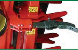
Ancora centrale Centre eradicator Dent efface-trace centrale Zentraler Spunlockerer
