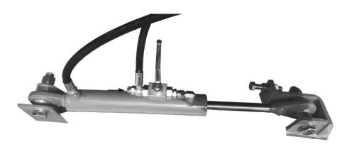
Pendant le transport c'est nécessaire de fermer le robinet du vérin pour la rotation de la machine, pour que la machine soit bloquée.
