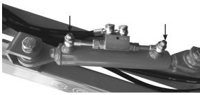
Pour régler la vitesse du piston on doit intervenir sur les régulateurs de flux indiqués sur la photo.
