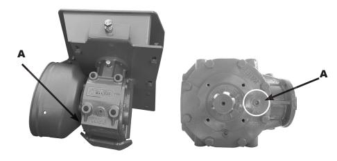
Pour contrôler le niveau d'huile, utiliser le bouchon **A**.
