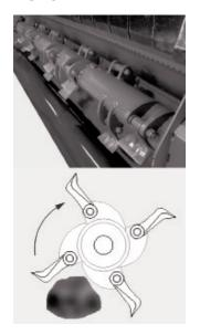
L'entretien du rotor est très important. Graisser les supports chaque fois après 10 heures de travail. Avant et après chaque utilisation, contrôler si le rotor et les supports des outils soient abîmés. Si le rotor est endommagé, contacter le revendeur de région pour le remplacer ou le réparer.
