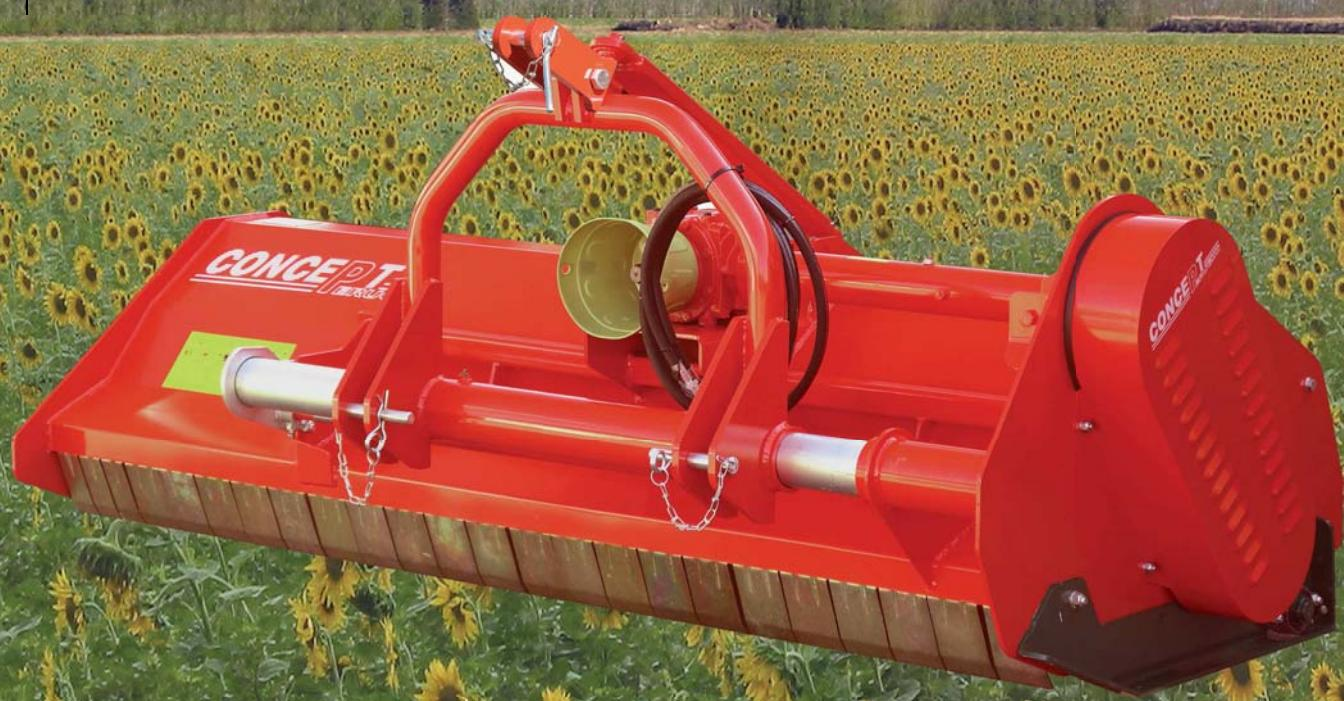
*Broyeur universel pour tracteur jusqu'à 90 hp*
