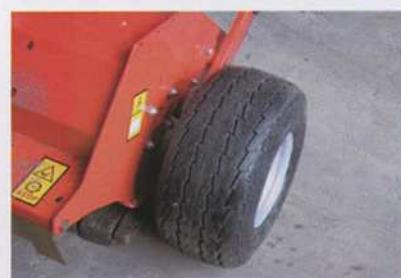
*Ruote da 18x8.50x8 per il minimo danneggiamento dei prati. Possono essere usate centralmente o posteriormente.*
